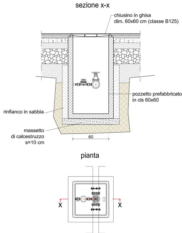
Pozzetto d'ispezione con chiusino in ghisa carrabile classe B125/D400 dim. int. 80x80 scala 1:20
