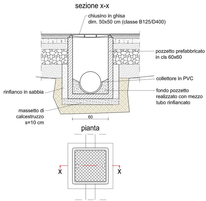
Pozzetto d'ispezione con contatore e chiusino in ghisa carrabile classe B125 dim. int. 60x60X120 cm scala 1:20
